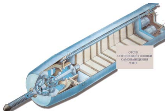
Рис. 19. Отсек ОГС 9Э410
