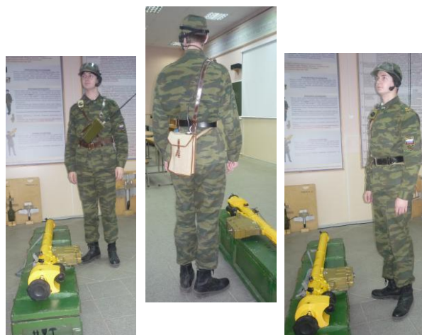
Рис. 68. Варианты крепления Р-157
