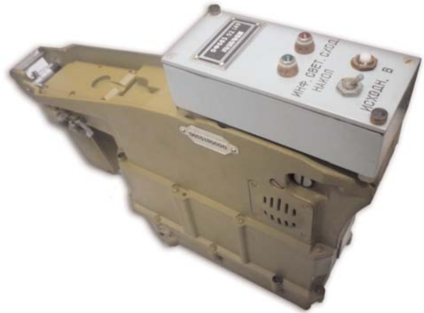
Рис. 78. Механизм тренировочно-практический с подстыкованным блоком контроля
